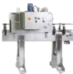
Túnel de Encolhimento
